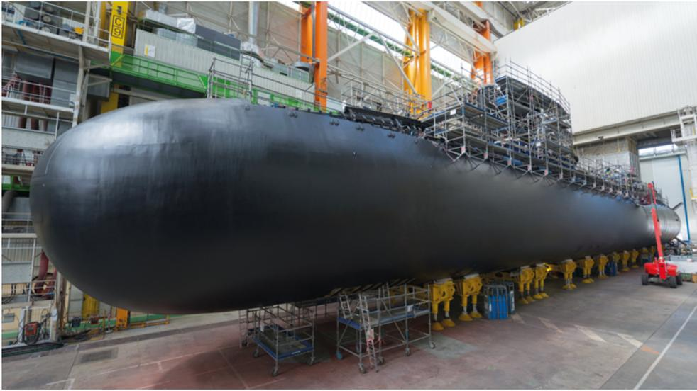
**CI-CONTRE :** Comme le rappelle Leonardo Gullo, délégué syndical CFE-CGC, “le sous-marin est le produit le plus complexe au monde.” À l’image du modèle Suffren de type Barracuda (photo ci-contre) ou du Scorpène, un long tube de 99 m pour 8,8 m de diamètre, conçu pour les déploiements océaniques à large rayon et assurant plusieurs missions : lutte anti-surface et anti sous-marine, intégration dans une force navale, opérations spéciales, surveillance de zones et blocus, renseignements...
